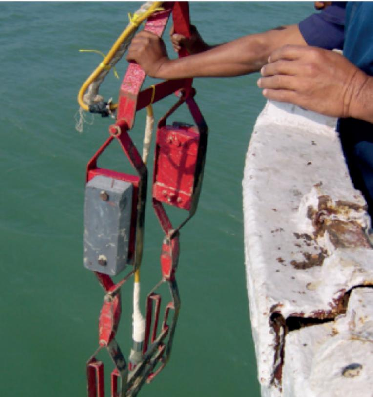
**Los radiotrazadores se emplean para monitorizar el transporte de sedimentos en el mar.**
