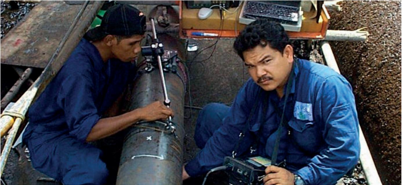
Unos técnicos inspeccionan un oleoducto de PETRONAS con métodos de END para determinar su calidad.
