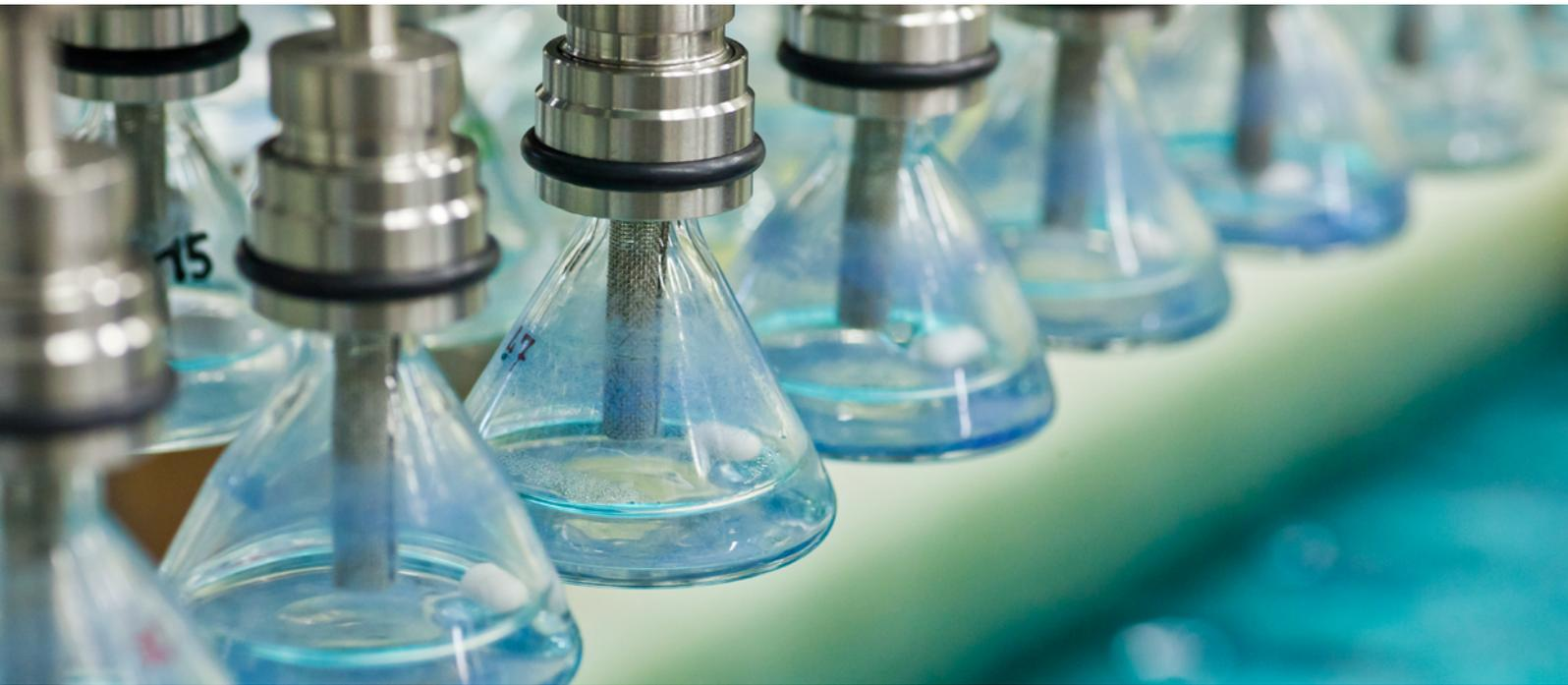
水的氧同位素指纹给出水的来源和年龄的信息，对它们的测量采用质谱测定法通过在实验室中用CO<sub>2</sub>气体平衡水样的方式进行。(照片来源：原子能机构)
