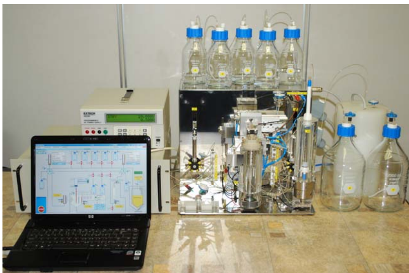
FIG. 1. “Kamadhenu”, generador electroquímico totalmente automático de estroncio-90/itrio-90 diseñado y construido por Isotope Technology Dresden con tecnología desarrollada en el marco de un PCI del Organismo. (Fotografía cortesía de J. Comor).
