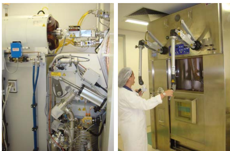
FIG. 2. Extractor de haces de un ciclotrón (izquierda) y celda caliente de producción (derecha) para la fabricación de radionucleidos para PET en Recife (Brasil).
