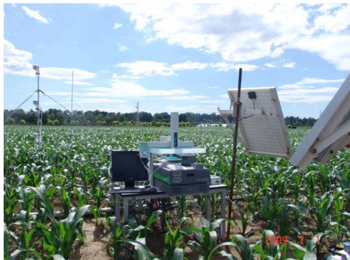
图 E-5. 利用常规技术和同位素技术测量玉米田中土壤蒸发作用和植物蒸腾作用（图片由梅旭荣教授提供）。
