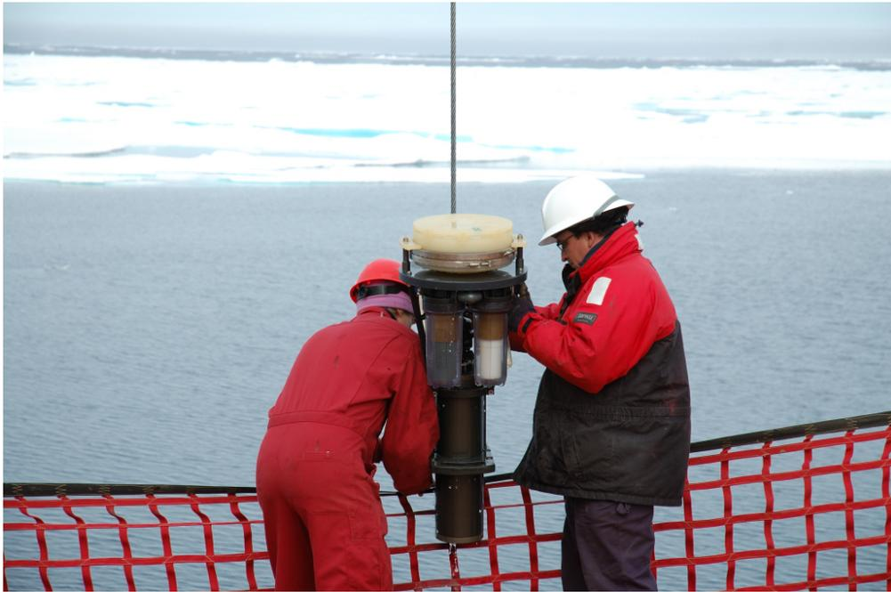
图 G-2. 正在部署原地大型泵，以便收集用于测量北冰洋水域放射性核素的颗粒物。
