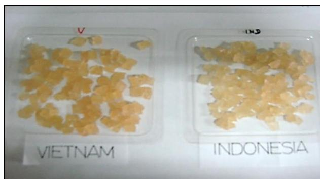
Маниоковый крахмал+гидроксид калия+акриловая кислота после облучения и сушки при подготовке суперабсорбентов воды.
