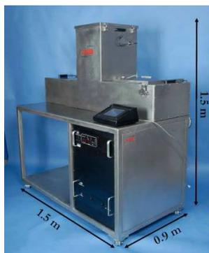
FIG. I-3. Unité autoblindée AEB de faible énergie pour le développement des applications des faisceaux d'électrons (source : <http://www.aeb.com/>)
