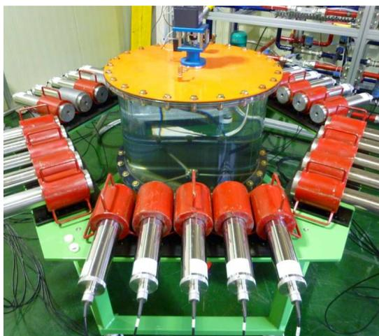
*Рис. 3. Промышленная система однофотонной эмиссионной компьютерной томографии для визуализации радиоиндикаторов  $^{68}\text{Ga}$  и  $^{137\text{m}}\text{Ba}$  из генераторов.*
