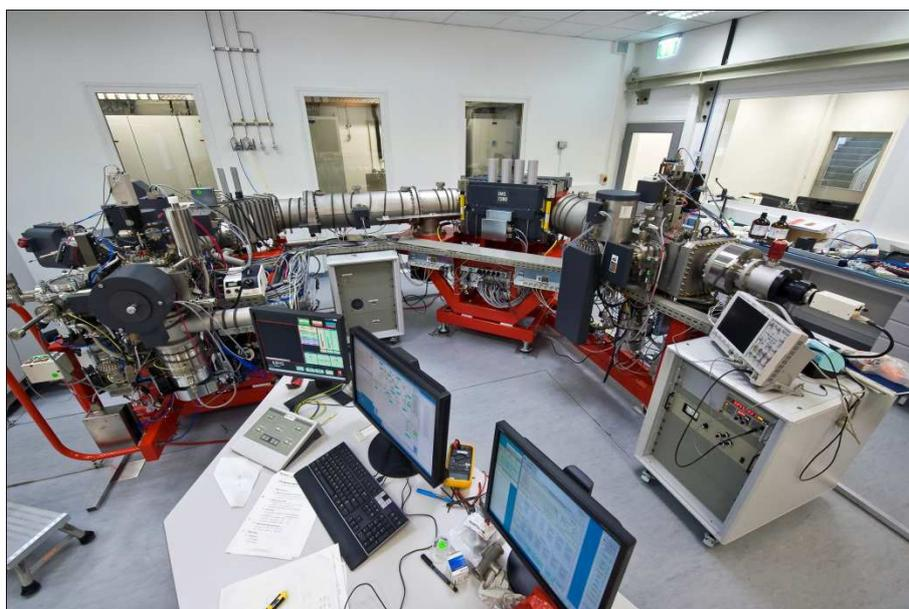
*РИС. 3. Вторично-ионный масс-спектрометр с увеличенной геометрией CAMECA IMS 1280-HR, работающий в дополнительных помещениях Чистой лаборатории в Зайберсдорфе.*
