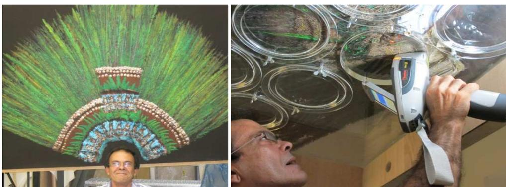
Fig. 5. Tocado mexicano del siglo XVI (izquierda) examinado con un espectrómetro de fluorescencia de rayos X portátil (derecha).
