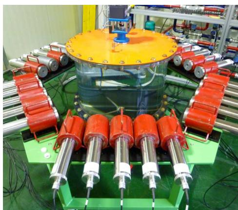
*Fig. 3. Sistema industrial de tomografía computarizada por emisión de fotón único para la visualización mediante radiotrazadores de  $^{68}\text{Ga}$  y  $^{137\text{m}}\text{Ba}$  de generadores.*
