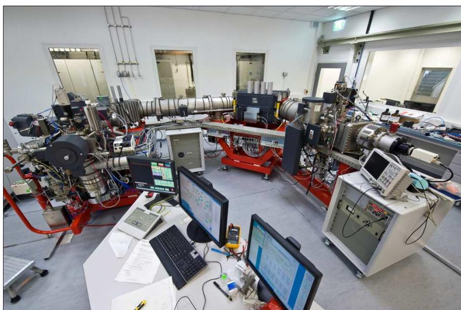
*Fig. 3. Espectrómetro de masas de emisión de iones secundarios de grandes dimensiones CAMECA IMS 1280-HR en servicio en la ampliación del laboratorio limpio, Seibersdorf.*
