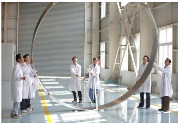
*FIG. B-2. Levage de bobines de correction supraconductrices destinées au projet ITER, Institut de physique des plasmas de Hefei (Chine).*
