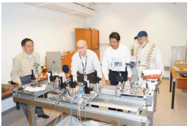
图 2. 在塞伯斯多夫原子能机构剂量学实验室举行的一次技术会议上进行 X 射线束国家剂量学标准的比对测量。
