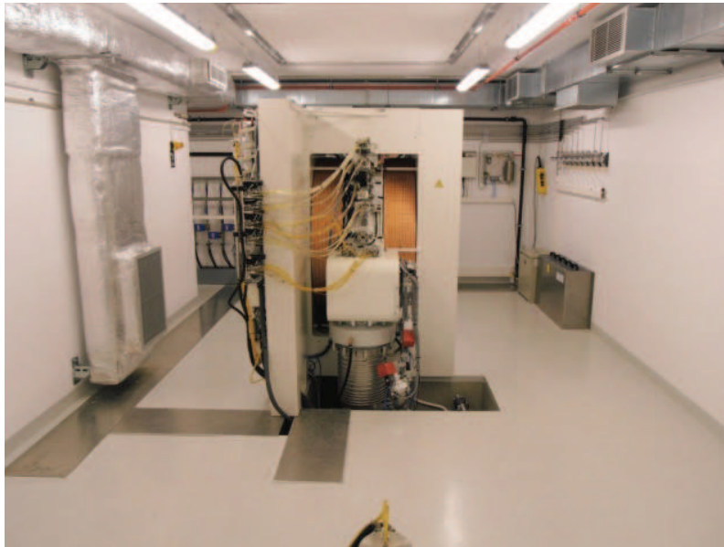
图 2. 波兰用于正电子发射断层照相放射性药物生产的回旋加速器。
