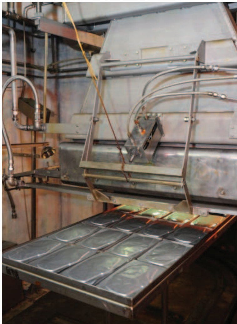
图 3. 马来西亚核能机构用于生物医学应用的纳米复合材料、生物基水凝胶的辐照处理工艺（交联和灭菌）。
