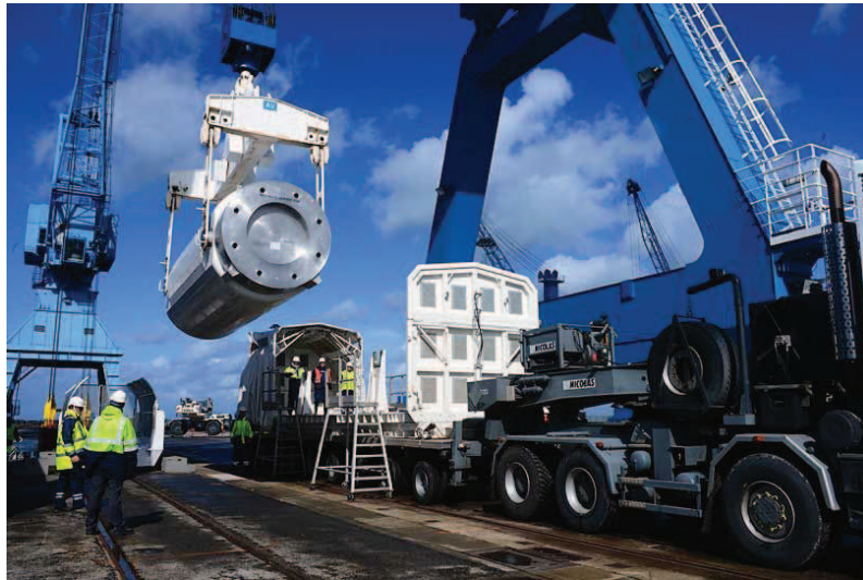
图 3. 正在装运中的载有放射性物质的运输屏蔽容器。
