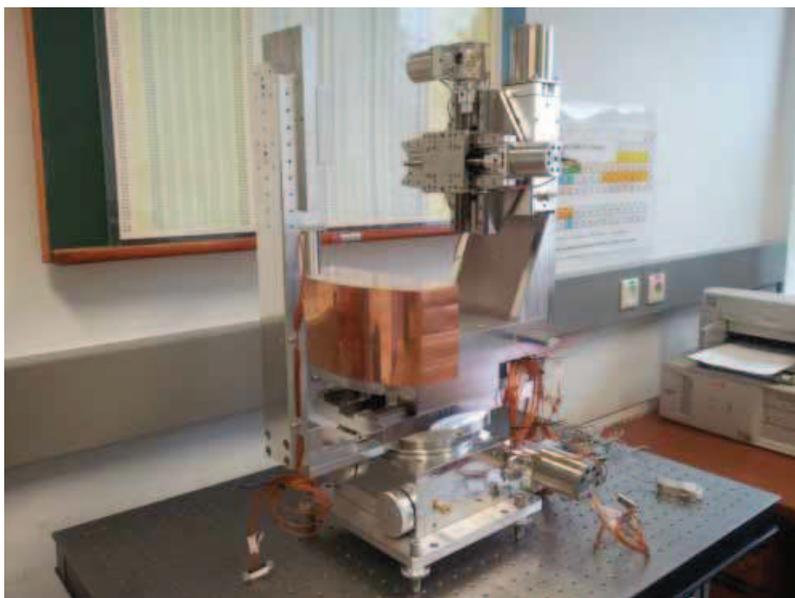
*FIG. 4. Montage d'essai du manipulateur d'échantillons motorisé à sept axes de l'enceinte ultravide au Laboratoire de la spectrométrie et des applications nucléaires de l'Agence.*
