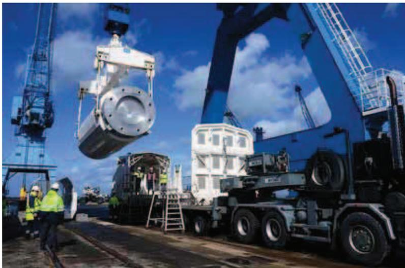
*FIG. 3. Château de transport de matières radioactives en cours de chargement pour expédition.*
