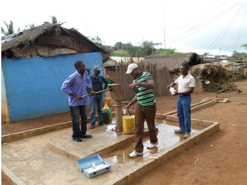
*Fig. 2. Campaña de toma de muestras para realizar análisis isotópicos e hidroquímicos de las aguas subterráneas en el sur de Ghana.*
