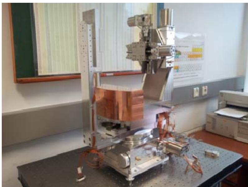
*Fig. 4. Equipo de ensayo para manipular muestras motorizado de siete ejes de la UHVC, en el Laboratorio de Espectrometría y Aplicaciones Nucleares del Organismo.*
