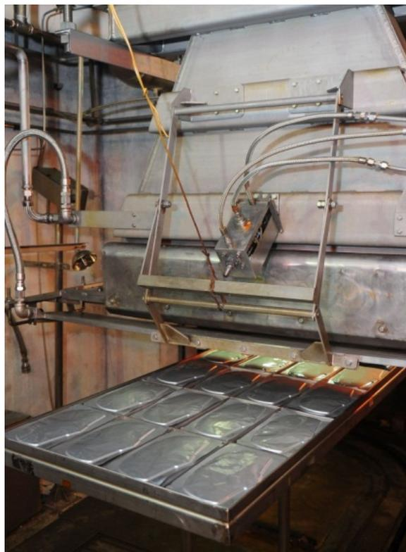
*Fig. 3. Tratamiento por irradiación (reticulación y esterilización) de los nanohidrogeles creados a partir de materiales de origen biológico para aplicaciones biomédicas en el Organismo Nuclear Malasio.*
