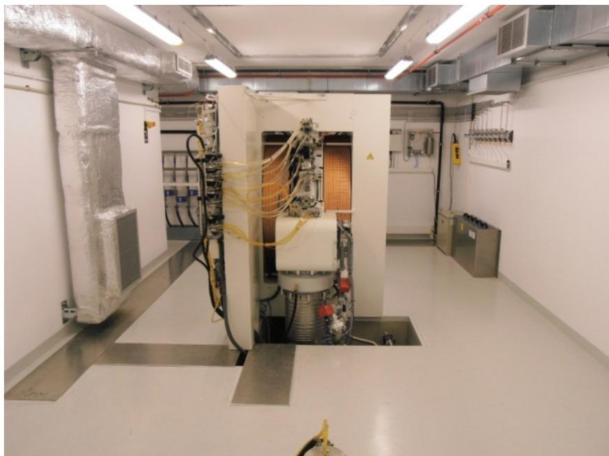
Fig. 2. Instalación de ciclotrón para la producción de radiofármacos para PET en Polonia.
