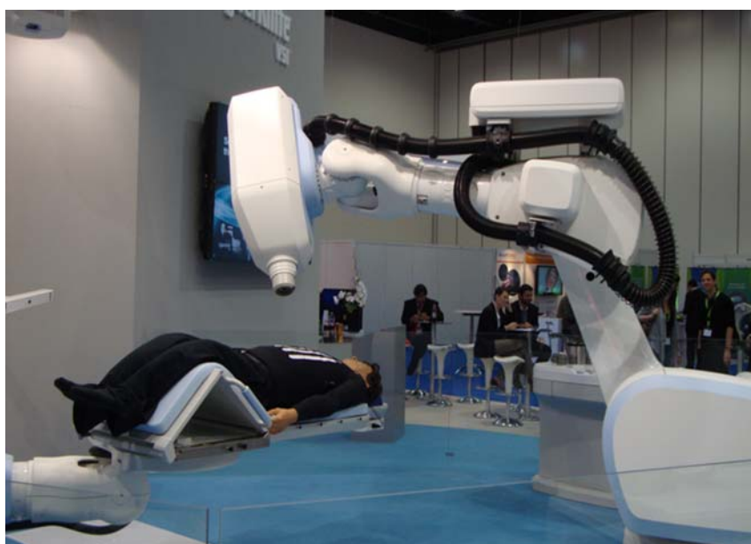
图 E-2. 机器人放射治疗是一种无框机器人放射外科治疗系统。该装置的两个主要组成部分是从小型直线加速器产生的辐射和使得能够将能量从任何方向传递到身体任何部位的机械臂。(照片：爱德华多·罗森布拉特，欧洲放射治疗和肿瘤学学会论坛，伦敦，2011 年。)
