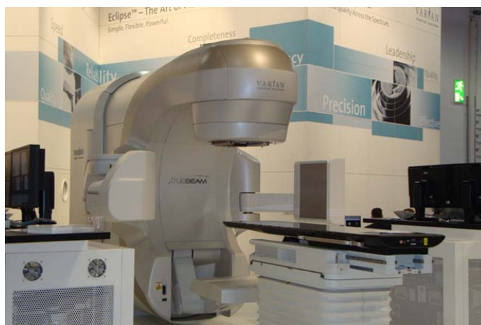
图 E-1. 为图像引导放射疗法装配的一台现代医用直线加速器。该装置使得能够通过治疗前频繁进行靶区和（或）健康组织成像和根据这些图像采取行动以调整辐射靶来提高放射治疗精度。（照片：爱德华多·罗森布拉特，欧洲放射治疗和肿瘤学学会论坛，伦敦，2011年。）
