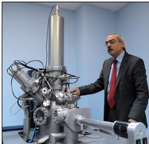
LEB/2/007 号项目：用于生物材料和有机材料表面元素、化学和结构分析的飞行时间次级离子质谱仪。
