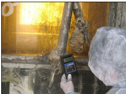
IRQ/9/007 号和 IRQ/9/009 号项目：热室和废物罐的放射学表征。
