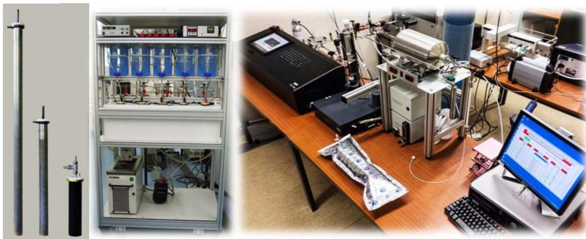
*РИС. 2. В 2013 году были завершены разработка и тестирование высокоэффективной системы электролитического обогащения трития (слева, в центре) для датирования подземных вод. Лазерный абсорбционный спектрометр (справа) в Лаборатории изотопной гидрологии МАГАТЭ проходит испытания на анализ содержания углерода-13 в растворенном углероде в пробах воды.*
