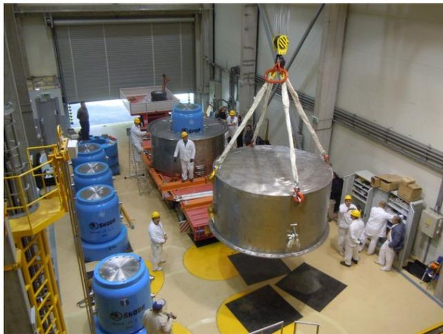
*РИС. 2. Приобретенные Агентством контейнеры двойного назначения (синего цвета) загружают в транспортные упаковочные комплекты ТУК-145/С для вывоза отработавшего ВОУ-топлива с площадки исследовательского реактора Научно-исследовательского института атомной энергии в Будапеште.*
