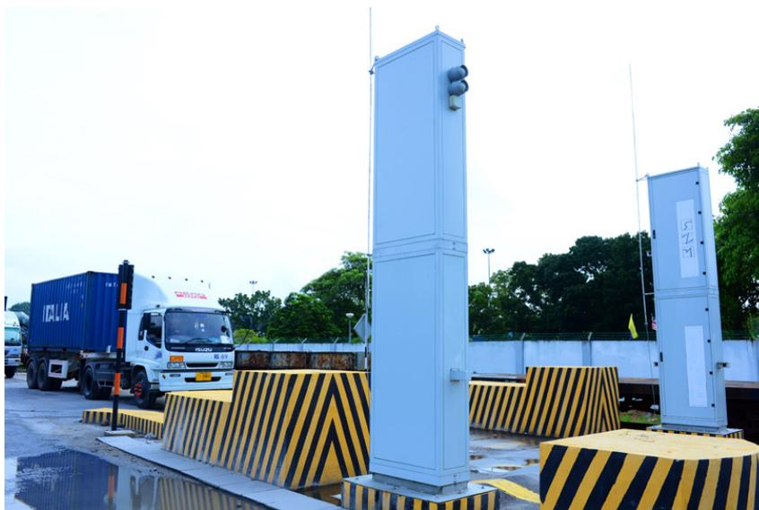
*РИС. 1. Радиационный порталный монитор на пункте пересечения границы между Таиландом и Малайзией. Это устройство позволяет обнаружить излучение в режиме реального времени, не нарушая при этом нормальный ход операций по импорту и экспорту.*
