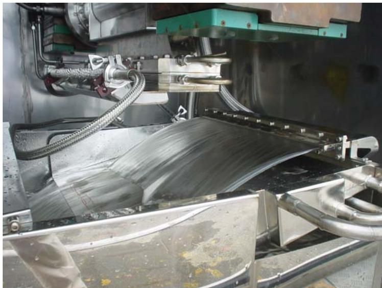
*РИС. 2. Электронно-лучевая обработка промышленных сточных вод делает их безопасными для сброса.
