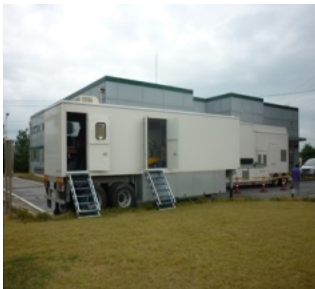
РИС. F-2. Передвижной электронный пучковый ускоритель, установленный на очистной станции (фото: КАЭРИ).
