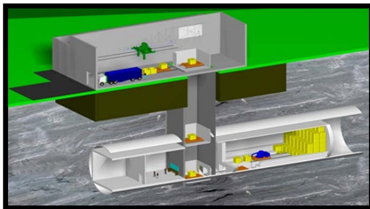
РИС. А-15. Концепция операций по помещению в планируемом в Российской Федерации хранилище НАО (изображение: Всероссийский проектный и научно-исследовательский институт комплексной энергетической технологии).
