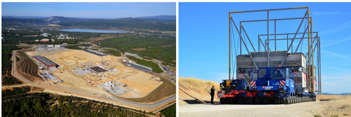
РИС. В-4. Площадка ИТЭР в сентябре 2013 года (слева). 800-тонный трейлер с тягачом с дистанционным управлением, имитирующий вес и размеры крупнейших грузов ИТЭР (10 м в высоту, 33 м в длину, 9 м в ширину); на испытаниях, длившихся четыре ночи подряд, он прошел "специальный маршрут" длиной 104 км со средней скоростью 5 км/ч (фото: ИТЭР).
