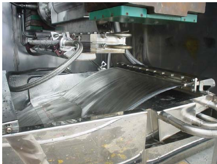
РИС. F-1. Обработка сточных вод с использованием электронного пучкового ускорителя (фото: «ЭБ-Тех», Республика Корея).
