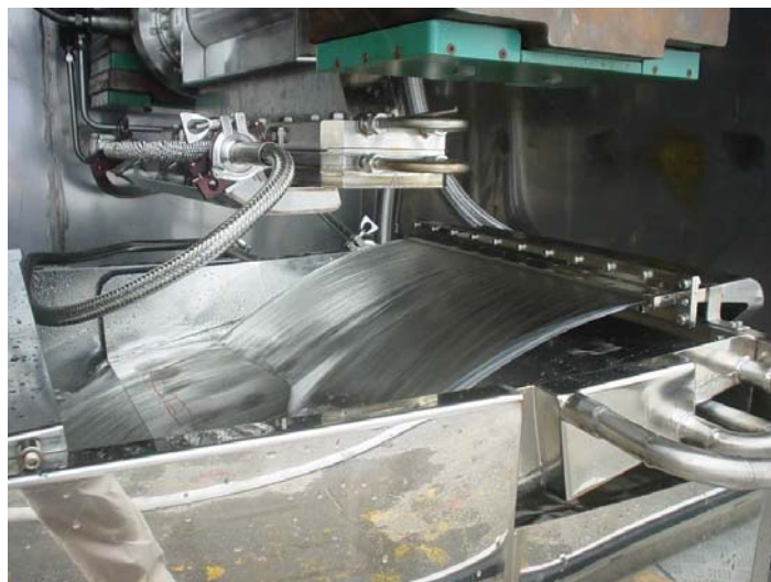
Fig. F-1. Tratamiento de aguas residuales usando un acelerador de haces de electrones (fotografía: EB Tech, República de Corea).
