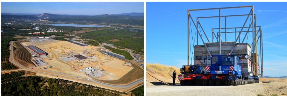
Fig. B-4. El emplazamiento del ITER en septiembre de 2013 (a la izquierda). El remolque de 800 toneladas con vehículo a control remoto, utilizado para imitar el peso y las dimensiones de las cargas más grandes del ITER (10 m de alto, 33 m de largo, 9 m de ancho), se desplazó, a título de prueba, por la carretera especial de 104 km (a la derecha), a una velocidad media de 5 km/hora durante cuatro noches consecutivas. (Fotografías: ITER).
