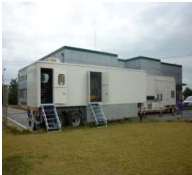
Fig. F-2. Acelerador de haces de electrones móvil instalado en la planta de tratamiento de aguas negras (fotografía cortesía del KAERI).
