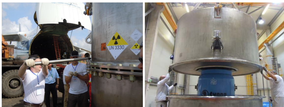
Fig. C-5. Izquierda: Ajuste de los pernos de embalajes especiales para el transporte de combustible de UME gastado desde el Instituto de Investigaciones Nucleares de Dalat (Viet Nam) hasta la Federación de Rusia. Derecha: Colocación de un sobreembalaje protector en un cofre de transporte que contiene combustible de UME gastado en el reactor de investigación de Budapest (Hungría). El sobreembalaje está diseñado para posibilitar el transporte aéreo.
