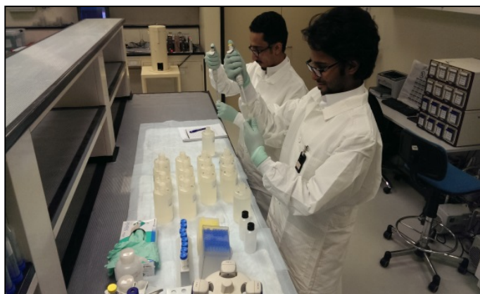
RAS/1/017: Preparación de materiales de referencia para oligoelementos del agua potable en la Ciudad “Rey Abdulaziz de la Ciencia y la Tecnología” (KACST).
