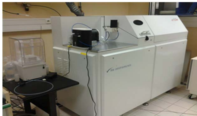
图 H-3. 高分辨率感应耦合等离子体质谱仪用于分析环境样品中的稳定铅同位素。
