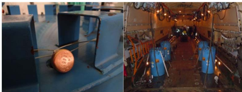
图 C-4. TK-S16 运输容器上的原子能机构保障封记（左图）。专为从哈萨克斯坦阿拉木图至俄罗斯联邦运输准备的运输容器（右图）。
