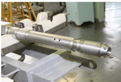
图 A-7. 先进 BREST-300 反应堆的原型燃料 — TVS-5 燃料组件。（照片由西伯利亚化学联合集团提供）
