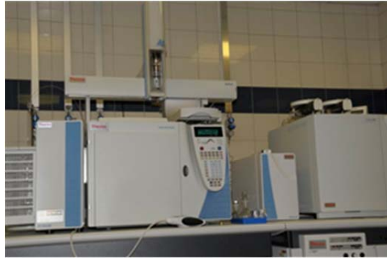
图 H-2. 同位素比质谱仪用于测量稳定氮和碳同位素比率，以供研究沿海富营养化过程。
