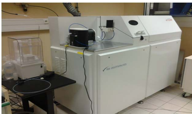
РИС. Н-3. Масс-спектрометр высокого разрешения с индуктивно связанной плазмой, используемый для анализа стабильных изотопов свинца в пробах окружающей среды
