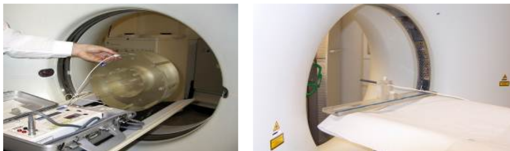
РИС. E-1. Измерение дозы в КТ на стандартном полиметилметакрилатном макете тела и в воздухе.
