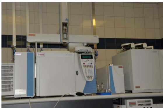
РИС. Н-2. Изотопный масс-спектрометр для измерения содержания стабильных изотопов азота и углерода в целях изучения процессов прибрежной эвтрофикации
