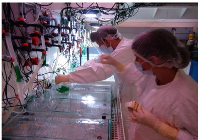
РИС. Н-1. Эксперименты с использованием радиоиндикаторов (кальция-45) для изучения воздействия подкисления океана на морские организмы.
