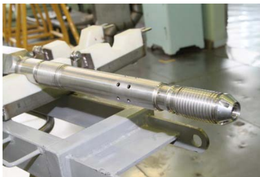
РИС. А-7. Тепловыделяющая сборка ТВС-5 – прототип топлива для усовершенствованного реактора БРЕСТ-300. (Фото: СХК)
