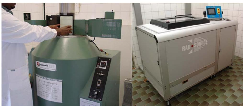
РИС. F-4. Гамма- (слева) и рентгеновский (справа) облучатели, используемые для стерилизации комаров-самцов. (Фото: МАГАТЭ)
