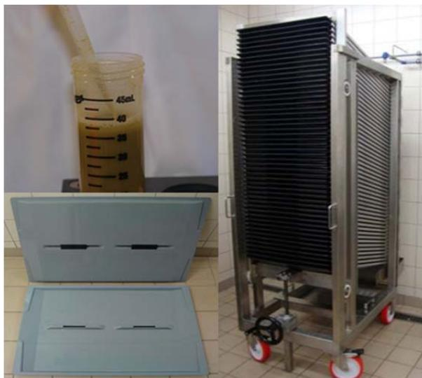
РИС. F-2. Жидкое личиночное питание, лотки и стойка, разработанные для массового культивирования комаров на личиночной стадии. (Фото: МАГАТЭ)
