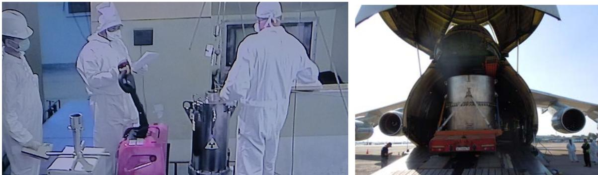
*РИС. С-6. Транспортный контейнер с облученным жидким ВОУ топливом (слева). Грузовик, перевозящий упаковку с контейнером жидкого ВОУ топлива, заезжает в грузовой отсек транспортного самолета, при помощи которого осуществляется возврат топлива с реактора ИИН-3М ОАО "Фотон" в Узбекистане в Российскую Федерацию (справа)*
