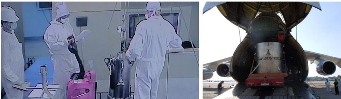
*Fig. C-6. Contenedor de transporte con combustible de UME líquido irradiado (izquierda). La carretilla que transporta el bulto con el contenedor de combustible de UME líquido es introducida en el avión de carga en que el combustible del reactor FOTON IIN-3M será repatriado de Uzbekistán a la Federación de Rusia (derecha).*
