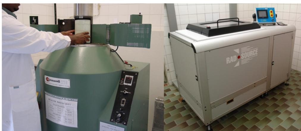
*Fig. F-4. Se utilizan irradiadores de rayos gamma (izquierda) o rayos X (derecha) para esterilizar a los mosquitos macho. (Fotografía: OIEA)*
