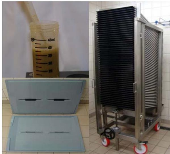
Fig. F-2. Alimento líquido para larvas, bandejas y portabandejas diseñados para la cría en masa de mosquitos en estado larvario. (Fotografía: OIEA)
