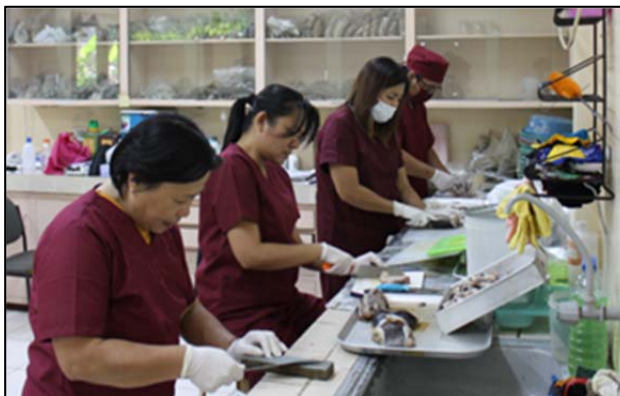
Проект RAS/7/021. Подготовка тканевых проб рыбы к анализу методом гамма-спектрометрии, Филиппинский институт ядерных исследований. Фото: Филиппинский институт ядерных исследований.
