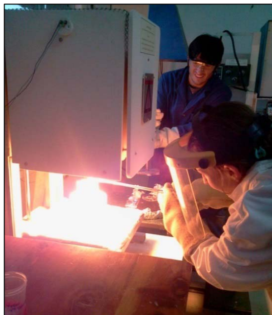
Проект ARG/9/013. Плавка стекла в электропечи в рамках исследования безопасного захоронения радиоактивных отходов, Лаборатория ядерных материалов, Атомный центр в Барилоче. Фото: CNEA.
