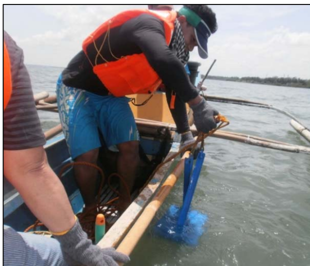
Проект RAS/7/021. Отбор проб отложений с помощью грейферного пробоотборника, пролив Гимарас, провинция Западный Негрос, Филиппины. Фото: Филиппинский институт ядерных исследований.
