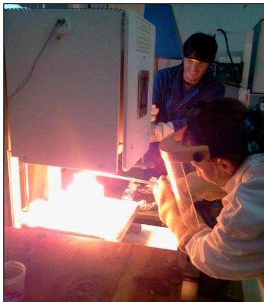
ARG/9/013: Fusión de vidrio en un horno eléctrico en el marco de las investigaciones sobre la disposición final de desechos radiactivos, Laboratorio de Materiales Nucleares, Centro Atómico Bariloche. Fotografía: CNEA.
