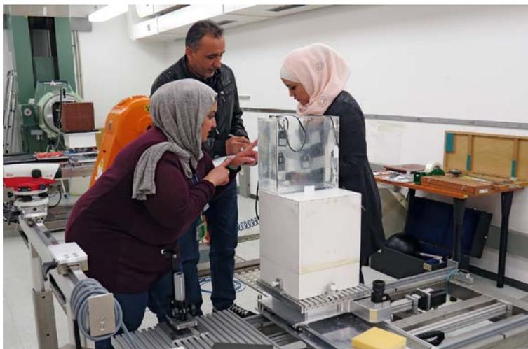
FIG. 2. Dispositif d'étalonnage en place lors du cours régional sur les étalonnages en dosimétrie individuelle effectués dans les LSED, dispensé au Laboratoire de dosimétrie de l'AIEA, à Seibersdorf (Autriche), en novembre.
