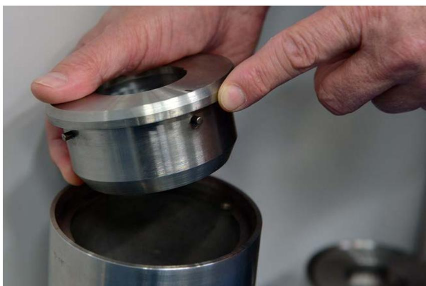
*FIG. 1. Conteneur, ou récipient pour stockage définitif, spécialement conçu pour le stockage en puits de sources radioactives scellées retirées du service.*
