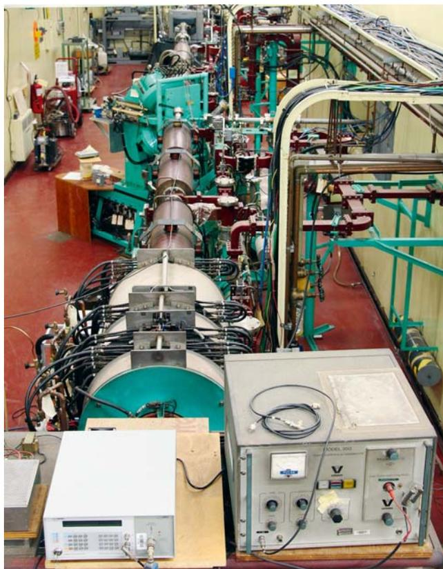
РИС. 1. Линейный ускоритель, используемый для производства молибдена-99 с захватом нейтронов  $(\gamma, n)$  на молибдене-100. (Фото предоставлено Р. Галяя, Канадский национальный научно-исследовательский совет; авторское право Содружества наций (Канада))
