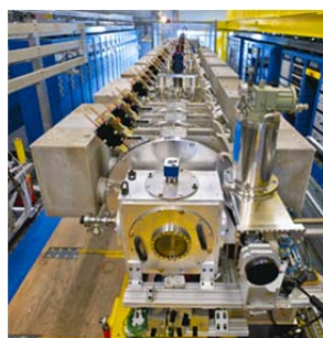
РИС. С-1. Ускоритель NDCX-II 12 в Национальной лаборатории им. Лоуренса в Беркли, США, позволяет исследовать структурную динамику в материалах. На фотографии показан 10-метровый ускоритель, блок мишени которого находится на переднем плане (Фото: Лаборатория в Беркли)
