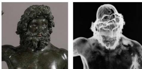
РИС. Н-3. Рентгеновский снимок позволяет предположить, что голова и туловище этой статуи Юпитера, расположенный в Виль д'Эврэ, Франция, были соединены между собой путем сварки. (Фото: Ж.Л. Бутэн)
