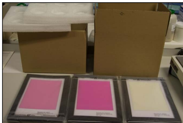
RER7008. Аттестационное испытание в рамках проекта RER7008: поставка новых эталонных материалов с радионуклидами, отпечатанных однотипным образом при помощи струйного принтера на листах бумаги (каждый цвет обозначает разный радионуклид). Фото: Ш. Тарьян/МАГАТЭ.
