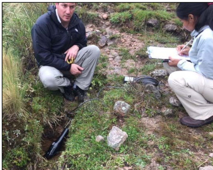
Лос-Хигантес, Кордоба, Аргентина. Замер гидрохимических параметров при помощи мультипараметрического зонда. Фото: НКАЭ, Аргентина.
