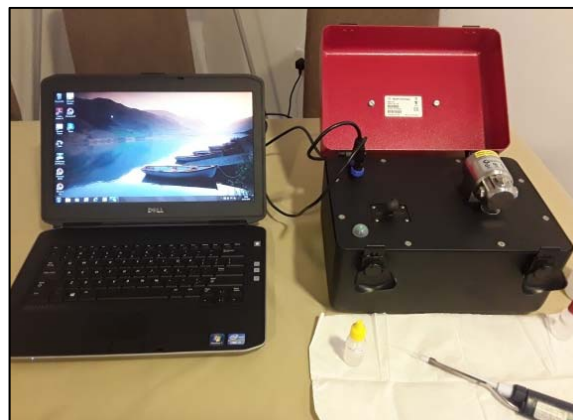
RER6034. Участники регионального семинара-практикума в Сараево (слева), переносной инфракрасный спектрометр с преобразованием Фурье (ИКФС) (справа). Фото: Виктор Овино/МАГАТЭ.
