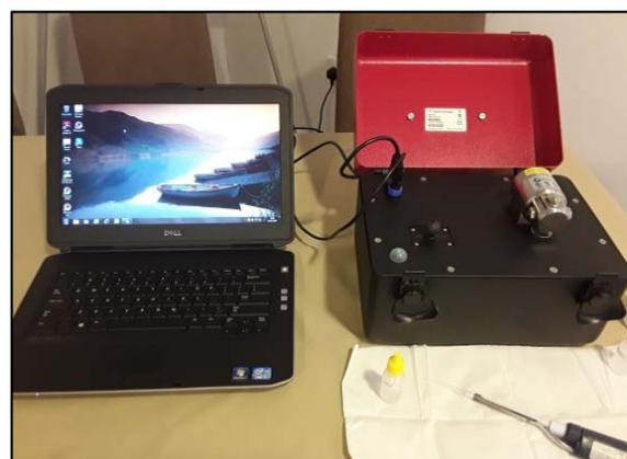
RER6034: Participantes en el taller regional de Sarajevo (izquierda), espectrómetro de infrarrojo por transformada de Fourier (FTIR) portátil (derecha). Fotografía: Victor Owino/OIEA.
