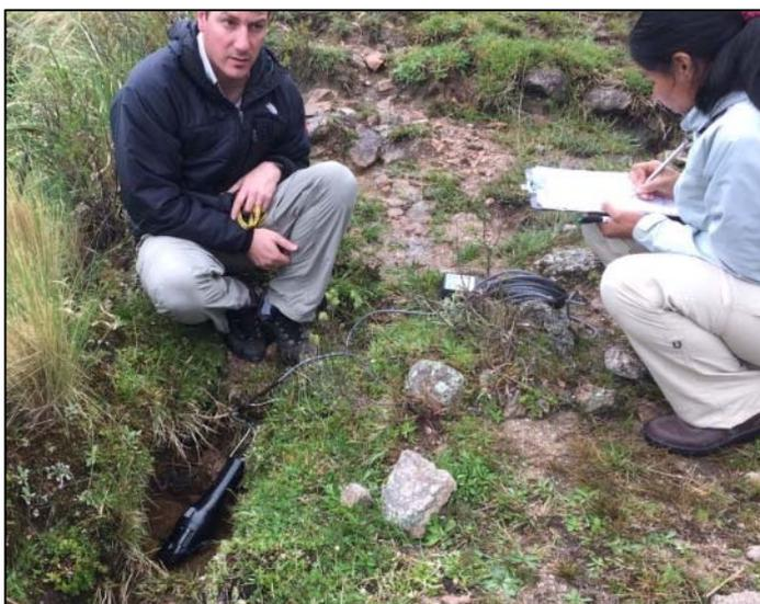
Los Gigantes, Córdoba (Argentina). Medición de parámetros hidroquímicos con una sonda multiparamétrica. Fotografía: CNEA (Argentina).
