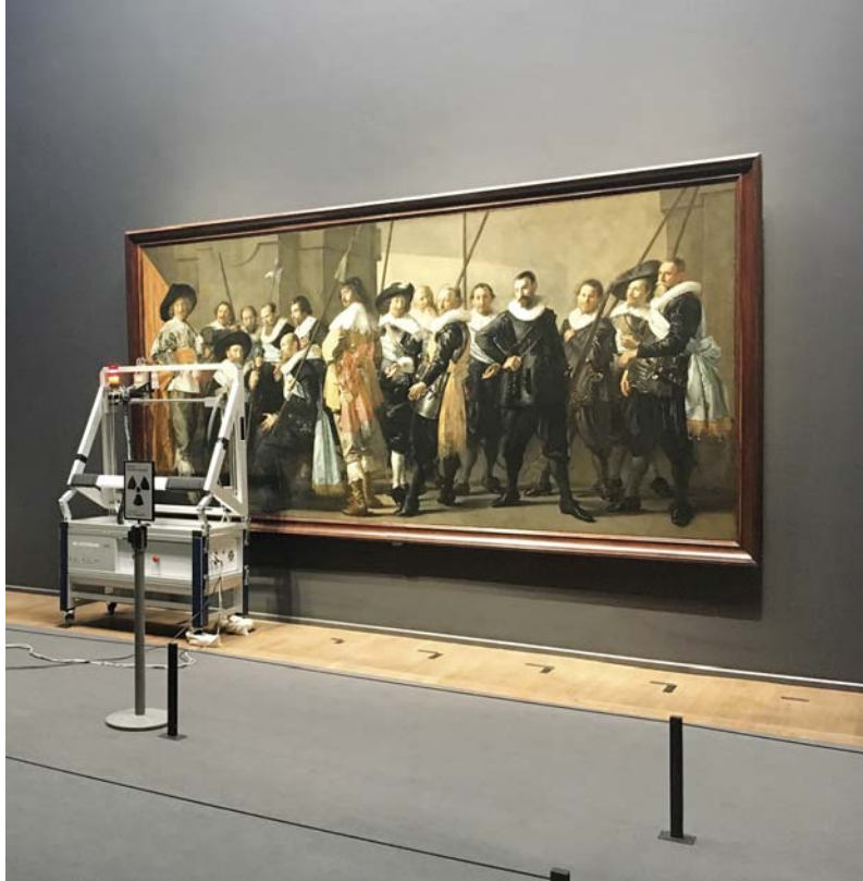
الشكل- ٣ لوحة للرَّسَّام فرانز هالس معروضة في المتحف الوطني في أمستردام، هولندا، أثناء تحليلها باستخدام تَأَلُّق الأشعة السينية المرئي بالعين المجردة (الماكروسكوبي). (الصورة مهداة من المتحف الوطني الهولندي)
