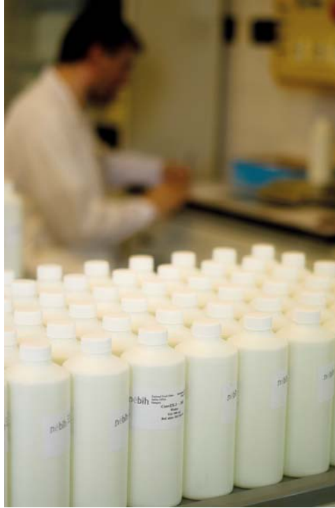
الشكل-١ - اختبارات مختبرية لعينات مياه تحتوي على نويدات مشعة عادة ما توجد في البيئة عقب وقوع حادث نووي، أجريت في إطار تمارين ConvEx3 في حزيران/يونيه.
