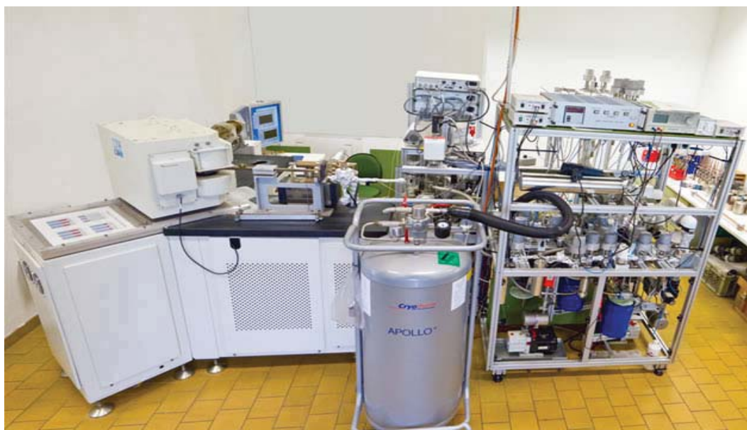
图 4：惰性气体分析的惰性气体质谱仪
