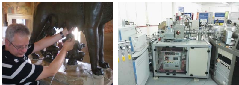
图 C-2. 在意大利莱切萨伦托大学测年和诊断中心对著名的青铜像“山羊狼”进行取样（左图）。该青铜像被认为是公元前 500 年左右伊特鲁里亚人的作品。采集了原始铸芯的样品，用光学显微镜选择了有机残留物，在加速器端站（右图）进行的放射性碳测龄给出的最终答案是：该雕像是在公元 1100—1200 年之间的某个时刻制造的，因此比过去认为的少了约 16 个世纪。（图片提供：萨伦托大学 G. Quarta、L. Calcagnile）。
