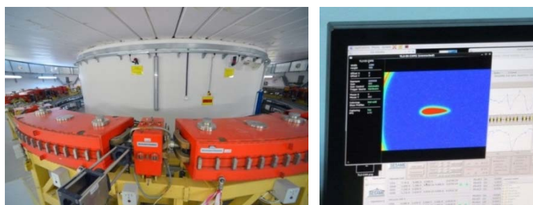
图 C-3. 同步光用于中东实验科学和应用中心的内存储环具有偏转和聚焦磁铁，电子束在加速时通过它们循环（左图）。由同步光用于中东实验科学和应用中心控制室数据采集系统实现可视化的第一个输出光束。（照片来源：原子能机构）
