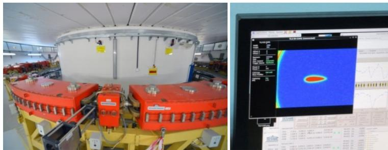
*FIG. C-3. Anneau d'entreposage intérieur de SESAME, équipé d'aimants de courbure et de focalisation à travers lesquels les faisceaux d'électrons passent lorsqu'ils subissent des accélérations (photo de gauche) et premier faisceau produit, visualisé par le système d'acquisition de données dans la salle de commande de SESAME (Photos : AIEA).*
