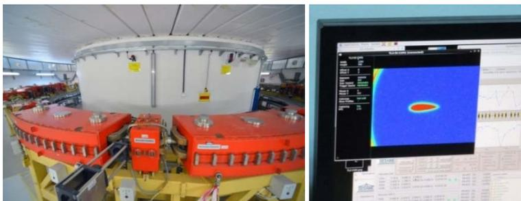
*Fig. C-3. Anillo de almacenamiento interno de SESAME, con los imanes deflectores y de focalización entre los cuales circulan los haces de electrones durante su aceleración (izquierda). Primer haz producido, tal como se vio en el sistema de adquisición de datos de la sala de control de SESAME. (Fotografías: OIEA)*
