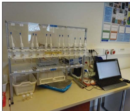
MAT0002 号项目：利用自动连续流动骨质脱落酸清洗系统进行碳-14 测龄。照片来源：M.Grima/马耳他遗产管理局。
