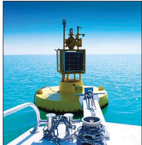
KUW7003 号项目：在科威特水域的不同地点设立了海水水质监测站。照片来源：L.Potterton/原子能机构。
