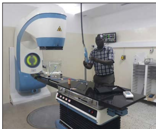
调试钴-60 远距治疗机。照片来源：乌干达癌症研究所。
