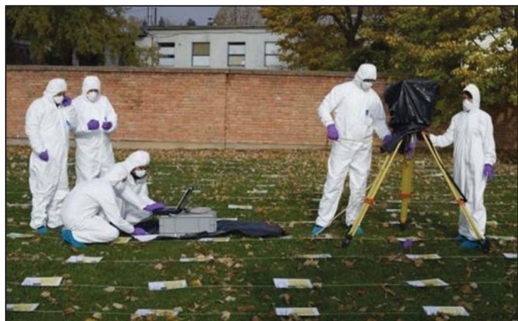
RER7008 号项目：在模拟的污染现场安装现场 \gamma 射线能谱测定仪。照片来源：S.Tarjan/原子能机构。
