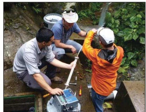
COS7005 号项目：用于泉水惰性气体分析的样品制备。照片来源：L. Castro/埃雷迪亚公用事业公司。
