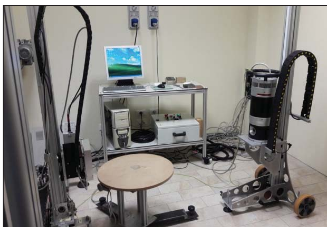
MAT0002 号项目：计算机断层成像，中型计算机断层成像系统（左）与用于大型物体的计算机断层成像系统（右）。图片：M.Grima/马耳他遗产管理局。
