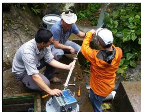
Projet COS7005 : Préparation d'échantillons pour l'analyse des gaz nobles dans de l'eau de source.
