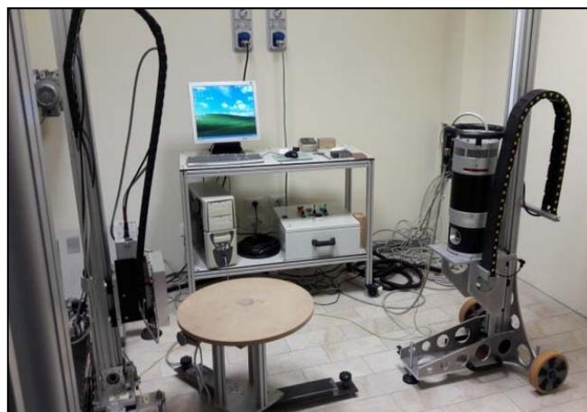
Projet MAT0002 : Imagerie CT, avec le système CT de taille moyenne (à gauche) et le système CT utilisé pour les objets de grande taille (à droite). Photos : M.Grima/Héritage Malta.
