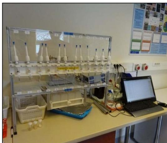
Projet MAT0002 : Datation au carbone 14 à l'aide du système automatisé ABA de nettoyage en continu des os. Photo : M.Grima/Héritage Malta.
