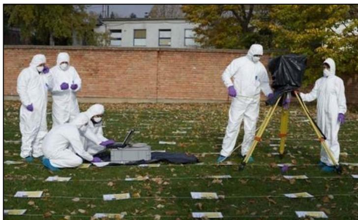
RER7008: Instalación de un espectrómetro de rayos gamma *in situ* en un emplazamiento contaminado simulado. Fotografía: S. Tarjan/OIEA.
