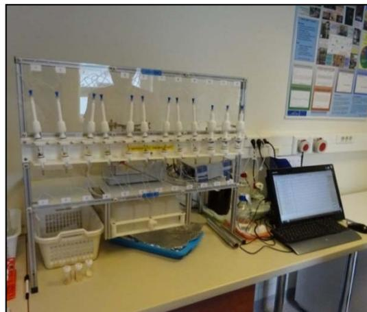
MAT0002: Datación por carbono 14 mediante el sistema automático de limpieza de huesos con flujo continuo de ABA (ácido-base-ácido). Fotografía: M. Grima/Heritage Malta.
