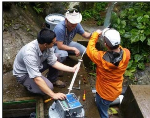
COS7005: Preparación de una muestra para el análisis de los gases nobles presentes en el agua de los manantiales. Fotografía: L. Castro/ESPH.
