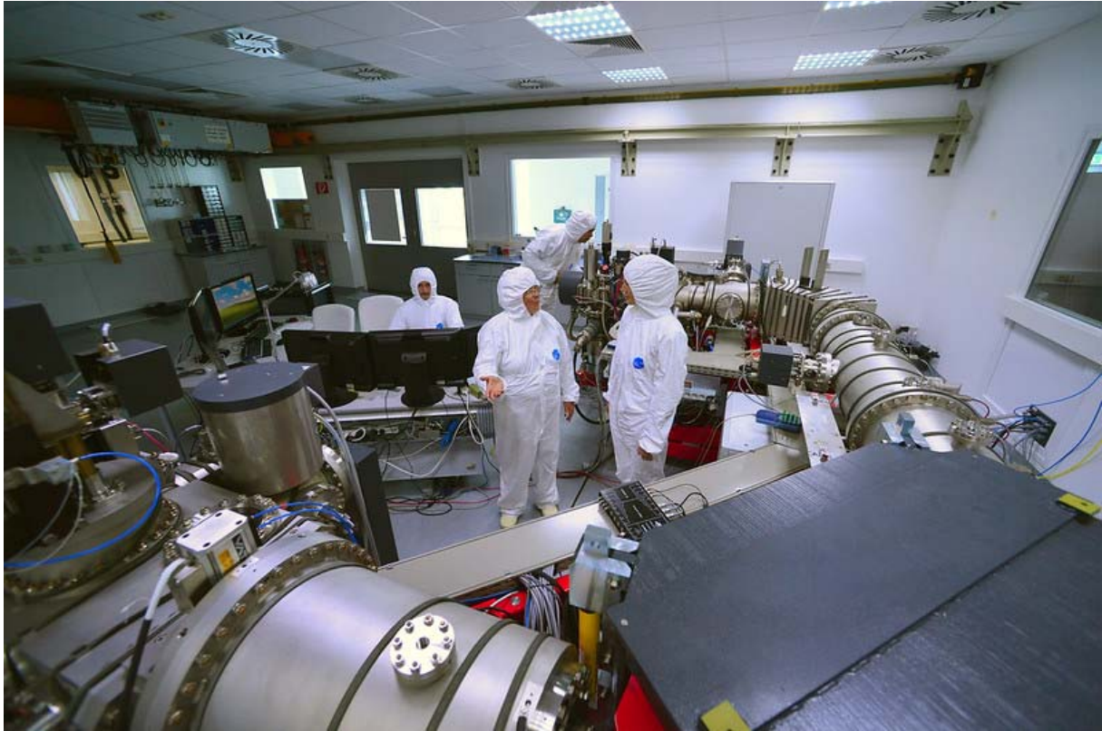
塞伯斯多夫保障分析服务环境样品实验室的次级离子质谱仪
