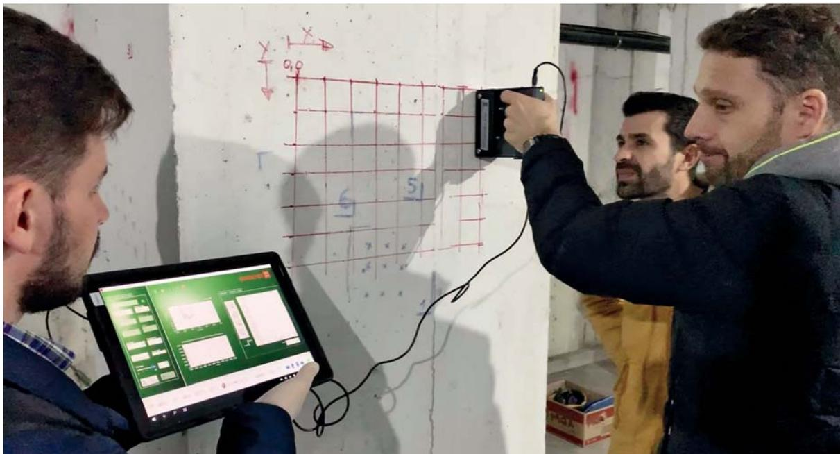
*РИС. 1. Проверка зданий в Албании с использованием оборудования для НРИ.*
