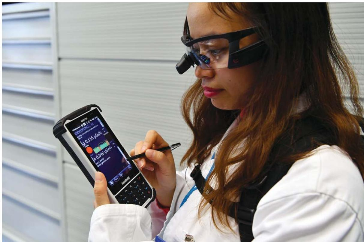
*РИС. 4. Инспектор Агентства по гарантиям проверяет настройки на портативном модуле ранцевого радиационного монитора, входящего в состав расширенного многокомпонентного набора для инспекторов (МКНИ). Внедрение МКНИ происходило в рамках Программы поддержки опытно-конструкторских и внедренческих работ для целей ядерной проверки на 2020–2021 годы (STR-393).*
