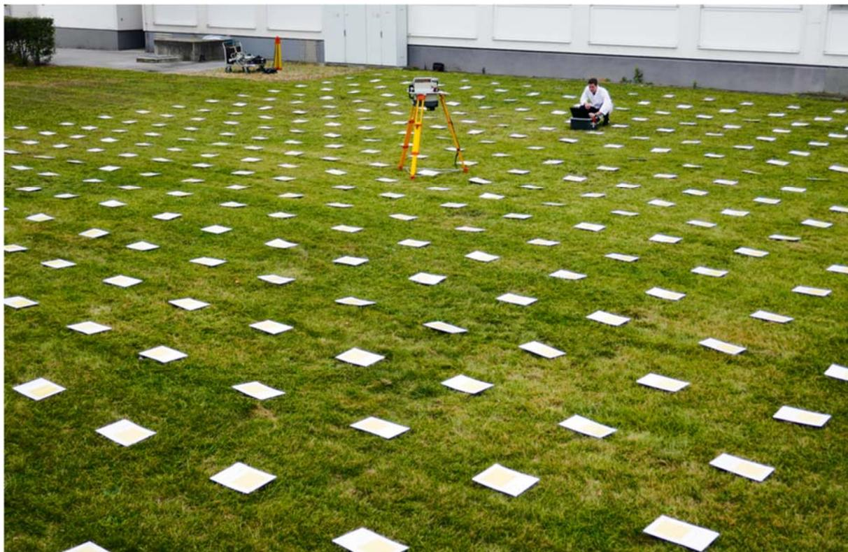
*РИС. 1. Калибровка гамма-спектрометров в полевых условиях с помощью разработанного в Агентстве новейшего метода, который предусматривает использование содержащих радионуклиды оттисков на листах бумаги. Этот метод теперь также применяется при проведении аттестационных испытаний..*
