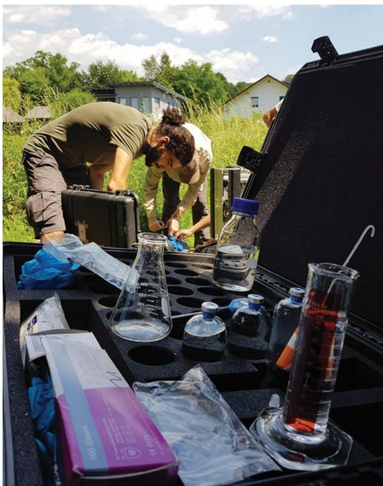
*РИС. 1. Отбор проб подземных вод для определения их возраста.*
