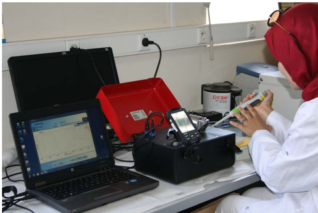
图 B.3. 用傅里叶变换红外光谱仪测量人体成分。（来源：Khalid El Kari/摩洛哥）
