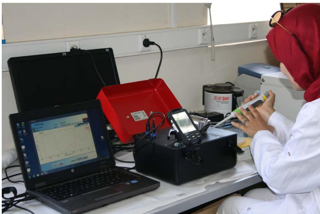
*FIG. B.3. Utilisation d'un spectromètre infrarouge à transformée de Fourier.
