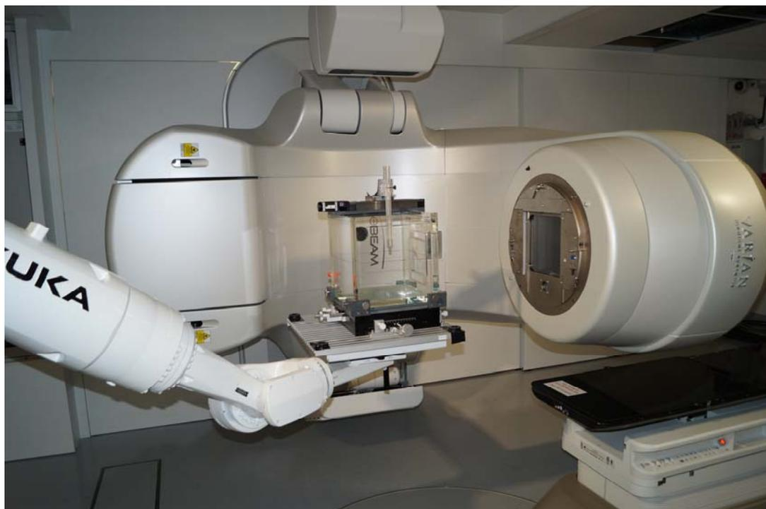
FIG. B.5. Calibration du LINAC à l'aide du banc robotique au Laboratoire de dosimétrie de l'AIEA à Seibersdorf. (Source : AIEA)
