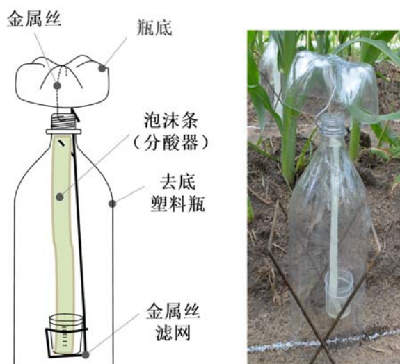
图 F-7. 测量氨挥发所用简易开放装置视图。Araújo 等人 (2009 年) 29 和 Jantalia 等人 (2012 年) 30 介绍过此装置细节。
