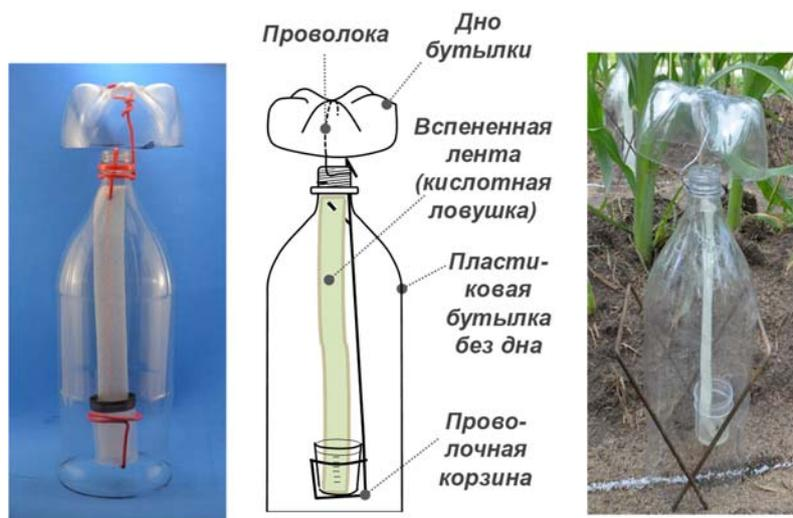
Рис. F-7: Вид простой открытой емкости, используемой для измерения испарения  $\text{NH}_3$ .
