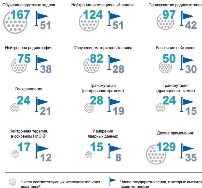
РИС. С-5. Распространенные виды применения исследовательских реакторов во всем мире<sup>a</sup>
