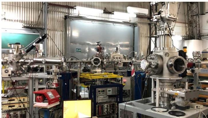
*РИС. С-1. Тандемная пучковая установка для облучения материалов, способных выдержать реакцию синтеза, ионами гелия в Институте им. Руджера Бошковича (Хорватия).
