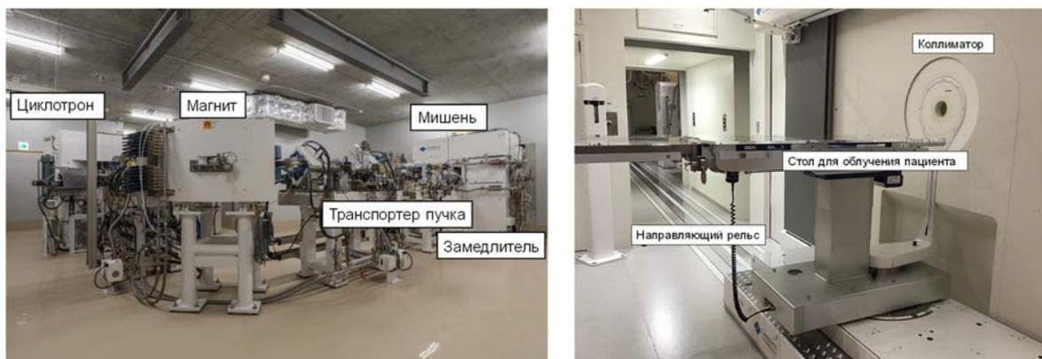
Рис. D-3. В центре БНЗТ на основе ускорителя: ускоритель и компоненты мишеней (слева) с системой позиционирования пациента (справа). (Фото: Медицинский центр БНЗТ района Кансай, Япония).
