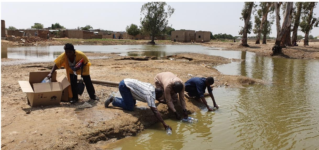
*FIG. B.3. Prélèvement d'échantillons d'eau lacustre au Tchad.
