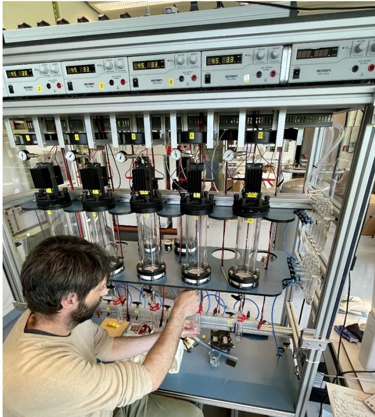
*FIG. B.1. Nouvelle méthode d'enrichissement en tritium fondée sur la technologie des membranes électrolytiques perméables. (Source : AIEA)*
