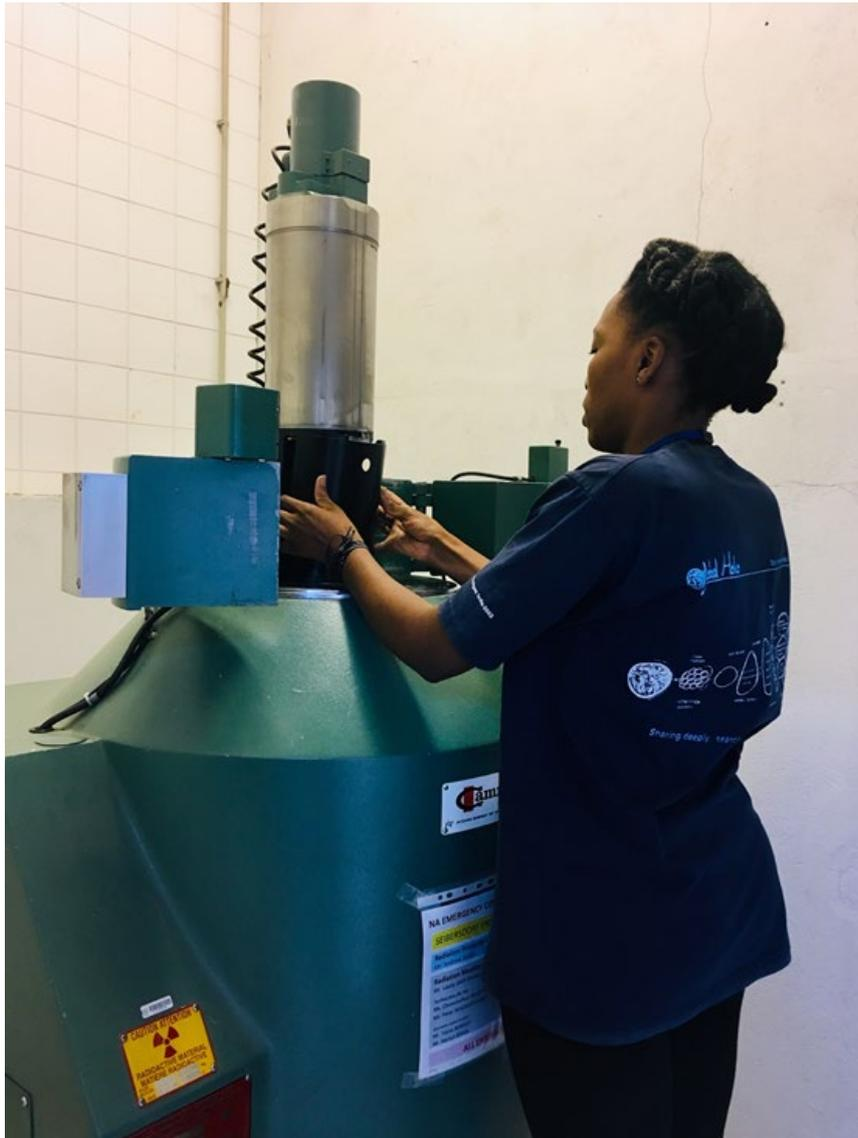
FIG. B.1. Des moustiques mâles sont introduits dans le compartiment d'une unité Gammacell 220 en vue de leur stérilisation. (Source : AIEA)
