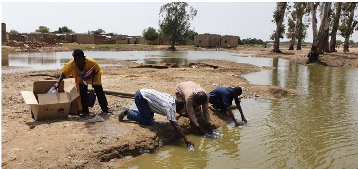
*РИС. В.3. Отбор проб озерной воды в Чаде.
