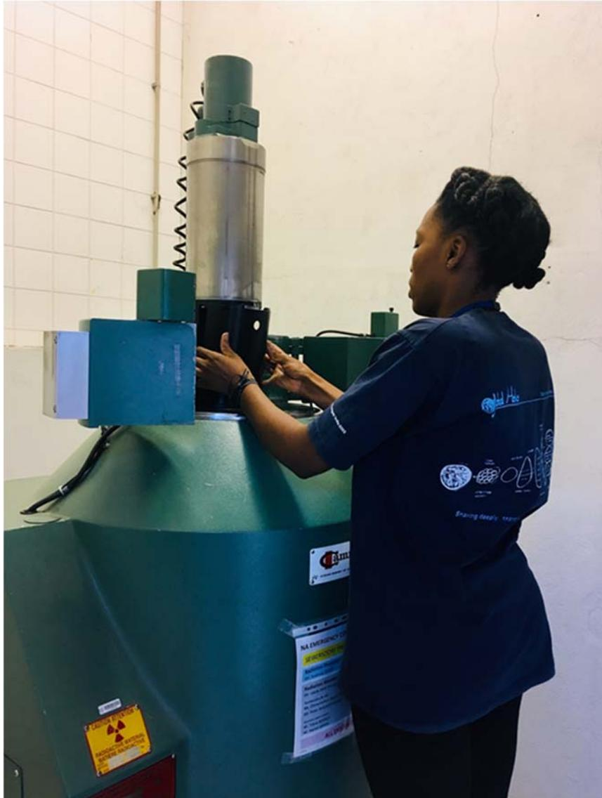
*РИС. В.1. Самцы комаров помещаются в камеру устройства «Gammacell 220» для стерилизации. (Источник: МАГАТЭ)*
