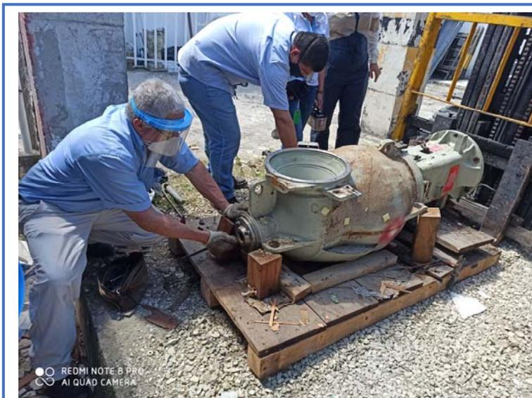
Expertos desmantelan un cabezal de teleterapia utilizado para la atención oncológica en Colombia en el marco de los preparativos para su almacenamiento en condiciones de seguridad tecnológica y física
