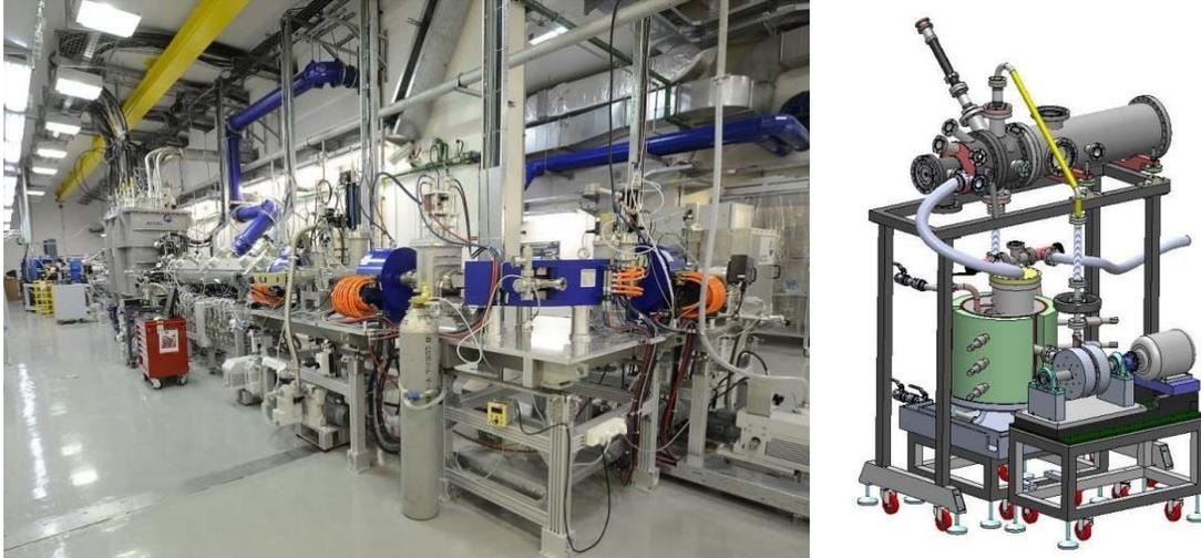
*FIG. D-4. L'accélérateur linéaire de protons/deutérons supraconducteur de forte puissance (200 kW) (à gauche), associé à la technologie innovante de production de neutrons à l'aide d'une cible de lithium liquide (à droite). (Image : Dan Berkowitz, Soreq Nuclear Research Center, Israël)*
