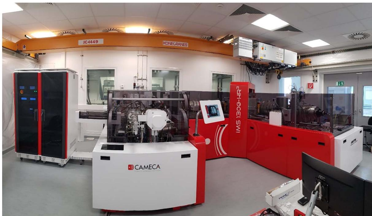
*Le nouveau spectromètre de masse à émission d'ions secondaires à large géométrie
