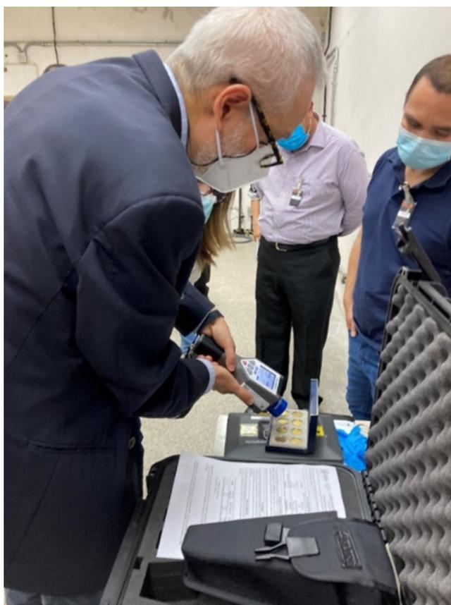
*Los participantes en una actividad de capacitación de COMPASS en Guatemala aprenden a utilizar un IdentiFINDER R400, espectrómetro de rayos gamma portátil de baja resolución.
