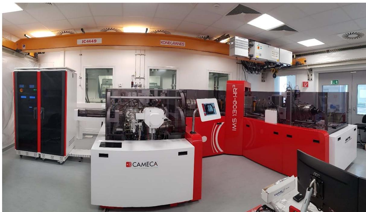
*El nuevo espectrómetro de masas de emisión de iones secundarios de grandes dimensiones (LG-SIMS).
