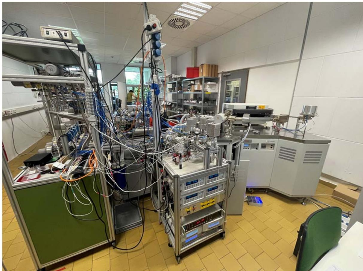
*FIG. B.2. Le nouveau système de spectromètre de masse de pointe détectant l'hélium 3 aux fins de l'analyse des teneurs en tritium grâce à la méthode de l'hélium 3 de décroissance, installé dans le laboratoire d'hydrologie isotopique. (Source : AIEA)*
