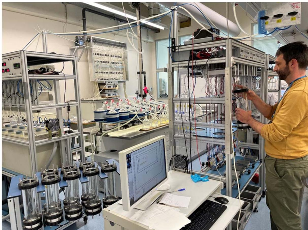
*FIG. B.1. Nouvelle méthode d'enrichissement en tritium fonctionnant grâce aux technologies de membranes électrolytiques polymères solides, avec le système de distillation en arrière-plan.
